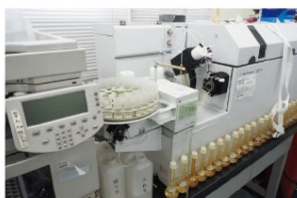
分析には大型の機器も使用する。この装置は温泉水の中のあらゆる金属成分の量を測定することができる
