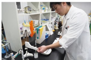
温泉は試験室でさらに細かく分析される。写真は電気伝導率を計測しているところ
