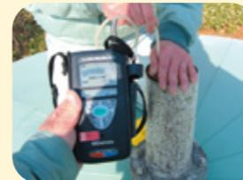
ガス抜き栓からのメタンガス測定
