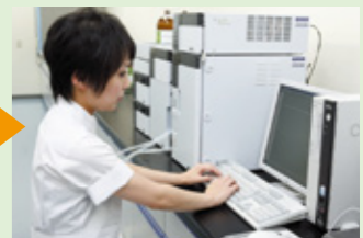
高速液体クロマトグラフ(HPLC)を用いて汚染濃度を分析。
