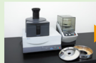
試料を高速粉碎機に入れ細かく粉碎した後、アフラトキシンを分離、抽出。
