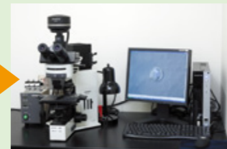
蛍光染色試薬にて染色し、蛍光顕微鏡で検出。
